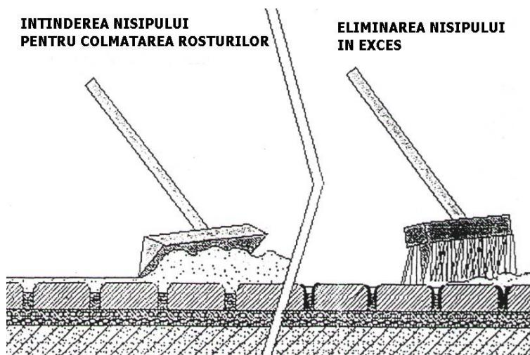
Se începe cu o primă colmatare înainte de vibrocompactare cu scopul de a accelera și îmbunătăți umplerea rosturilor. Apoi se așterne din nou nisipul de colmatare și se freacă cu peria pentru a împinge nisipul în rosturi. Întrucât colmatarea rosturilor este graduală se recomandă să nu se efectueze imediat curățirea finală.
